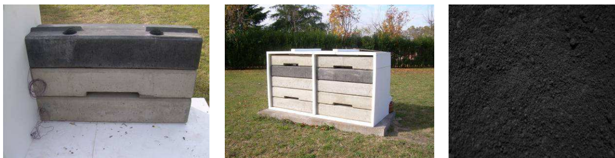
Fig. 6: Pieza del MAC pigmentadas, sin pigmentar (hormigón natural) y colorante negro de humo.
